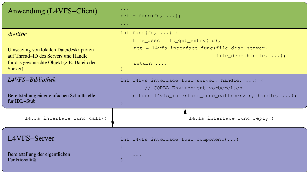
Abbildung 8: Architektur von L4VFS am Beispiel der Funktion func() für die IDL-Schnittstelle interface .
