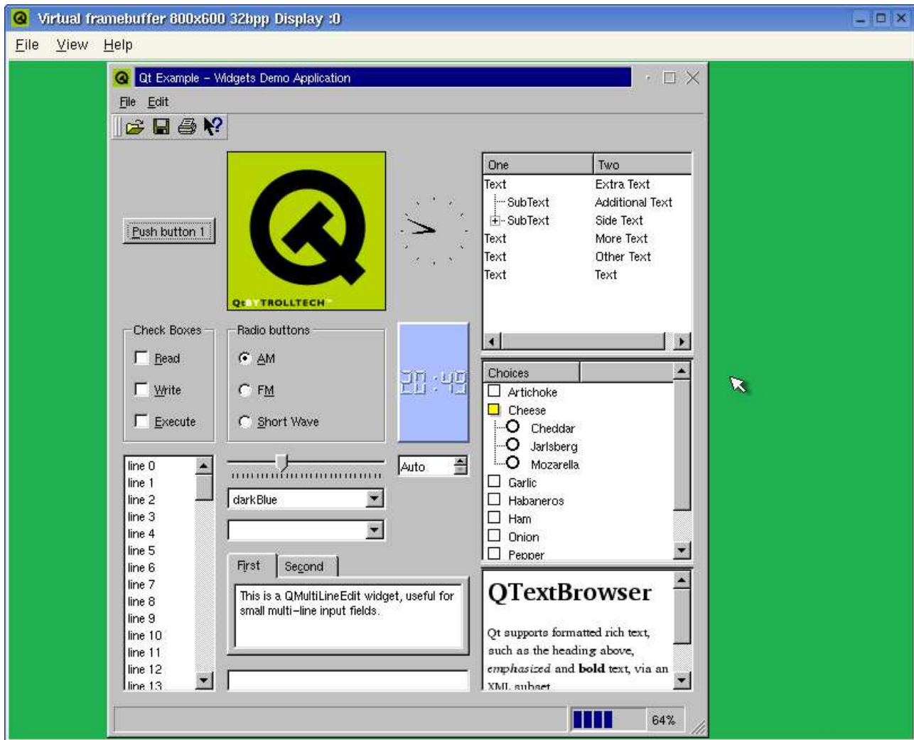
Abbildung 4: Beispielprogramm widgets für Qt/Embedded: Das Programm läuft als Qt/Embedded-Anwendung unter einem normalen Linux. Die Grafikausgabe erfolgt über den Qt/Embedded Virtual Framebuffer .
