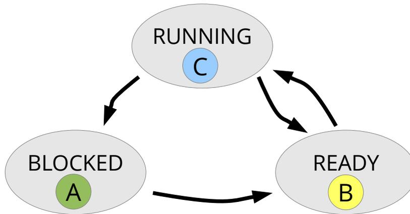
Prozess A hat einen E/A-Vorgang gestartet und ist in den Zustand BLOCKED übergegangen. Da A die CPU nun nicht benötigt, hat das Betriebssystem den Prozess C ausgewählt und von READY in RUNNING überführt. Es fand ein **Kontextwechsel** von A zu C statt.
