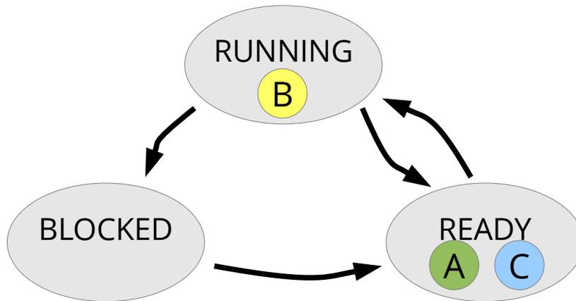
Die E/A-Operation von A ist nun abgeschlossen. Daraufhin wird A nun READY und wartet auf die Zuteilung der CPU.
