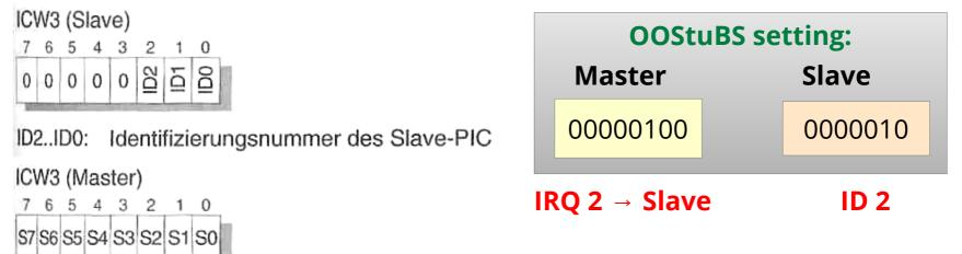
S7..S0: 0=zugehörige IR-Leitung ist mit Peripheriegerät verbunden oder frei 1=zugehörige IR-Leitung ist mit Slave-PIC verbunden
